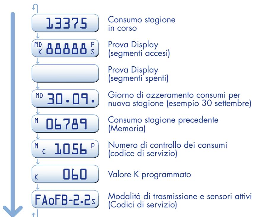
Il ripartitore di calore viene programmato in funzione del calorifero su cui è installato, secondo alcune specifiche quali la potenza del calorifero, il materiale costruttivo, la tipologia ed altro.
